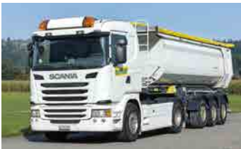
2-Achser Sattelschlepper mit Kippauflieger
