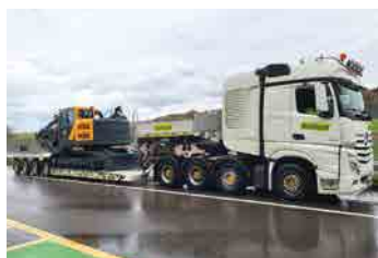
4-Achser Sattelzugmaschine mit Tieflader
