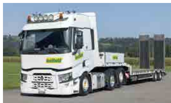
3-Achser Sattelzugmaschine mit Tieflader
