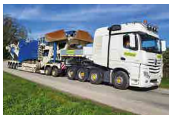
6-Achser Sattelzugmaschine mit Tieflader
