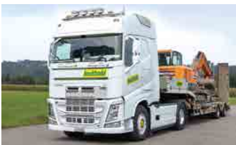
2-Achser Sattelzugmaschine mit Tieflader
